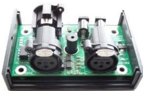
Ilustracja 3: Widok od strony "OUT" , Dwa żeńskie złącza XLR-3
